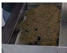
L'assorbente Oil-Catcher Premium viene cosparsa all'interno della vasca
