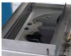
Perdita d'olio in una vasca contenente acqua
