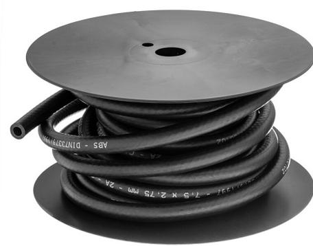
Tubo a pressione per il pompaggio di carburanti con e senza piombo, ma non per biodiesel. Miscele di biodiesel o miscele di bioetanolo (ETBE) fino a un massimo del 7 - 10%. Prodotto secondo la specifica DIN 73379/1997 Tipo 2A.
