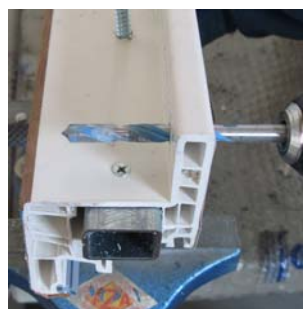
foratura su PVC, plastica, materiali stratificati
